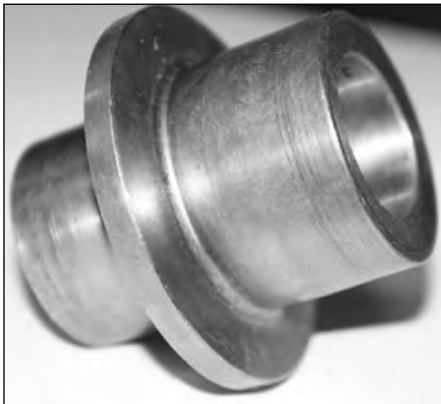
Рис. 8. Раскатанная деталь с фланцем
