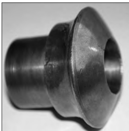
Рис. 4. Конус, раскатанный на первой стадии формообразования детали с фланцем
