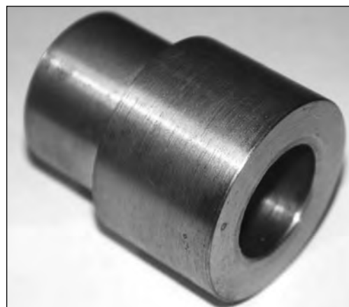
Рис. 2. Заготовка под раскатку детали с фланцем
