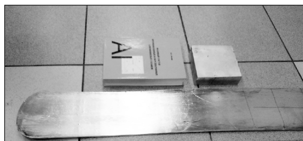
Рис. 1. Внешний вид экспериментального слитка и полученный из него лист
