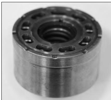
Рис. 1. Биметаллическое изделие с бронзой БрО10С2Н3
