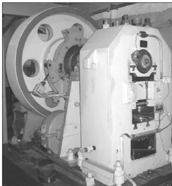
Рис. 1. Общий вид кулачкового пластометра разработки ИМАШ УрО РАН
