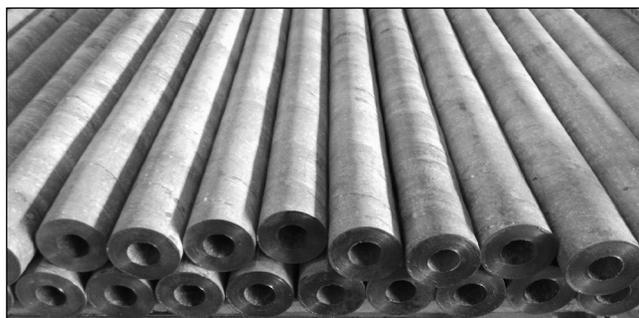
Рис. 5. Внешний вид готовых труб из технического титана ВТ1-0
