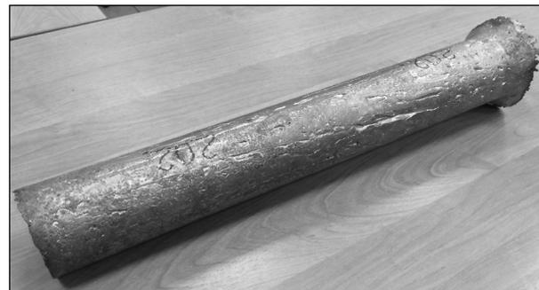
**Рис. 10.** Внешний вид отливки электрода из наномодифицированного жаропрочного сплава на основе NiAl
