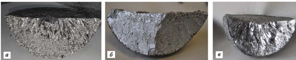
**Рис. 6.** Внешний вид макроструктуры слитков (массой 1–1,45 кг) синтезированных сплавов Cr–Mo (Al) (*a*), Cr–W (Al) (*б*) и Cr–Al (*в*)
