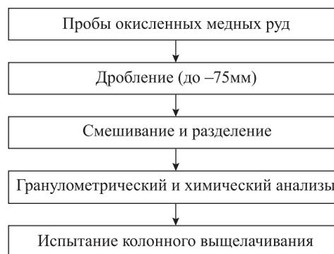
Рис. 1. Последовательность пробоподготовки и химического анализа
