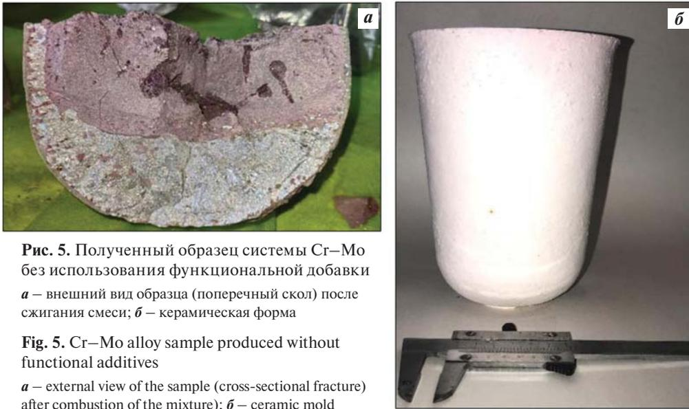
**Рис. 5.** Полученный образец системы Cr–Mo без использования функциональной добавки *a* – внешний вид образца (поперечный скол) после сжигания смеси; *б* – керамическая форма
