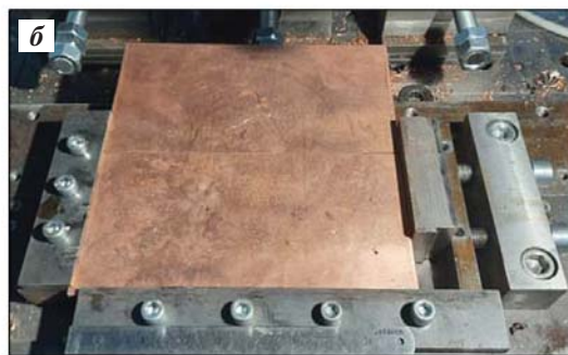
Рис. 6. Установка для СТП: общий вид (а) и оснастка для закрепления восстанавливаемой плиты и присадочного материала на сварочном столе (б)
