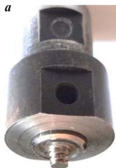
Рис. 7. Внешний вид сварочного инструмента из жаропрочного сплава (а) и схема процесса плоскостной СТП (б) S – нагрузка; W – скорость вращения инструмента, об/мин; V – скорость сварки, мм/мин; \alpha – угол наклона, град
