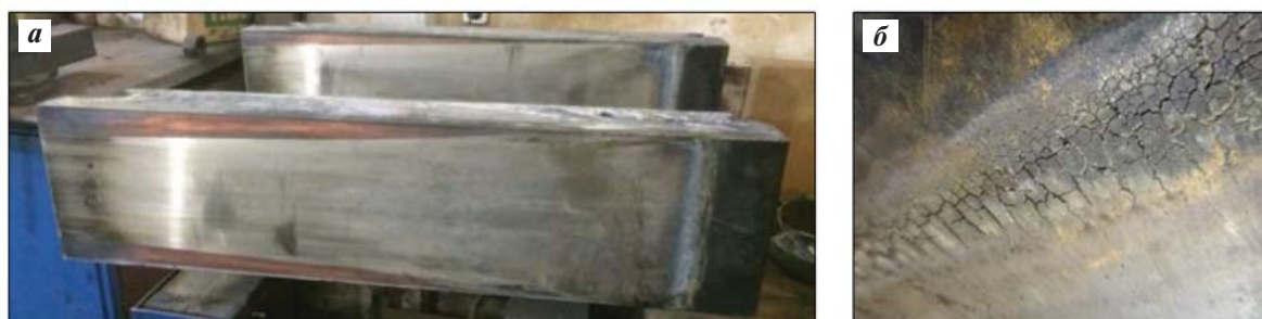
Рис. 2. Дефекты гальванических покрытий: износ (а) и тепловые трещины (б)
