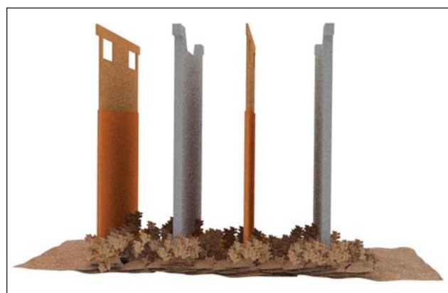
Рис. 2. Модель полного замыкания электродов при касании осадка нижней части электродов
