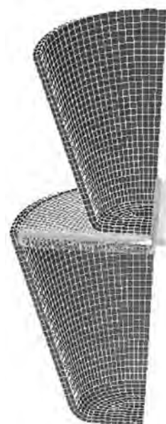
Рис. 5. Модель штамповой оснастки с разбиением на конечные элементы
