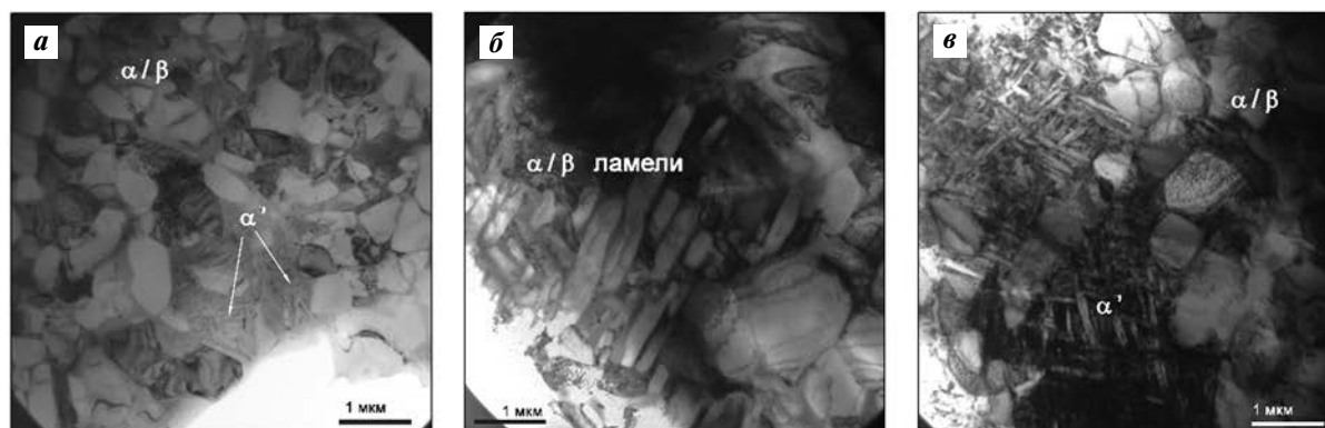
Рис. 5. Светлопольные изображения микроструктуры ЗТВ после 2-проходной (а), 3-проходной (б) и 4-проходной (в) фрикционной перемешивающей обработки
