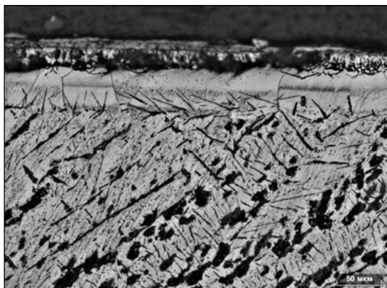
Рис. 1. Боридный слой на титане VT1-0 (смесь 1) Fig. 1. Boride layer on VT-1.0 titanium (Mixture 1)
