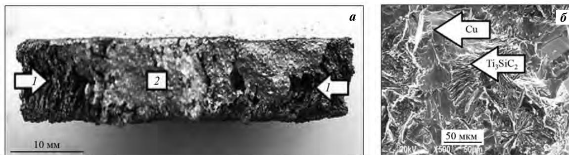
**Рис. 3.** Макрофотография скола нижнего образца  $Ti_3SiC_2$  после пропитки расплавом  $Cu-10\%Si$  с задержкой зажигания верхнего шихтового брикета в течение 10 с (а) и микроструктура участка пропитки (б) [83]
