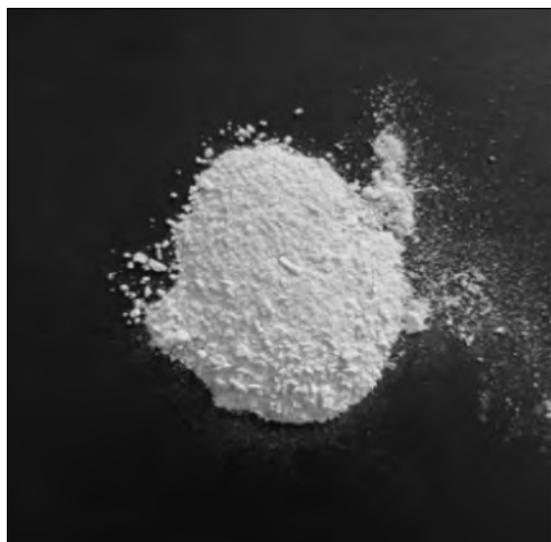
**Рис. 4.** Фотография образца криолита, полученного из фторсодержащего раствора гидromеталлургической обработки пробы лежалого шлама
