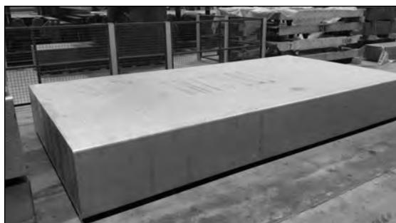
Рис. 1. Внешний вид крупногабаритного промышленного слитка толщиной 500 мм из сплава 1580
