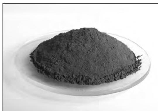
Рис. 1. Фотографическое изображение пробы свинцово-цинкового концентрата Кони Мансур
