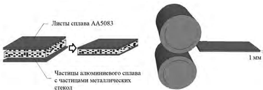
Рис. 1. Схема получения листов методом прокатки
