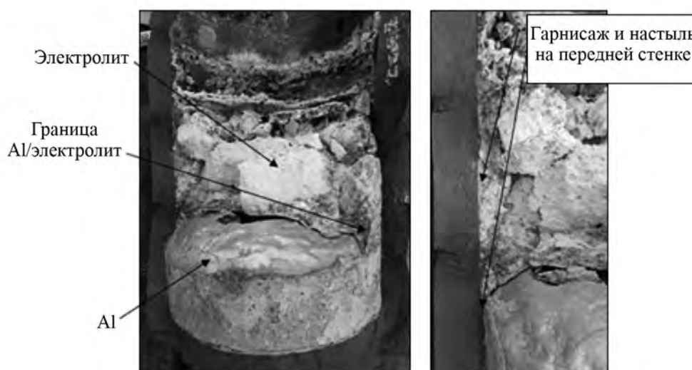
Рис. 7. Разрез ячейки после охлаждения (половина тигля)
