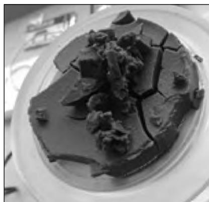
**Рис. 3.** Внешний вид твердого остатка, полученного после центрифугирования промышленных стоков титаномагниевого производства
