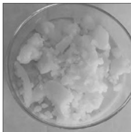
Рис. 6. Внешний вид остатка, полученного при вакуумной возгонке фугата ( $P < 50$  мбар,  $t = 70$  °С,  $\tau = 30$  мин)
