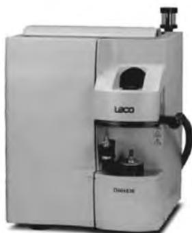
Анализатор кислорода, водорода, азота OIH-836 (LEKO, США)
