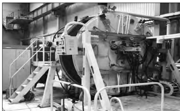
Рис. 2. Установка центробежного распыления нового поколения УЦРТ-9 [2]
