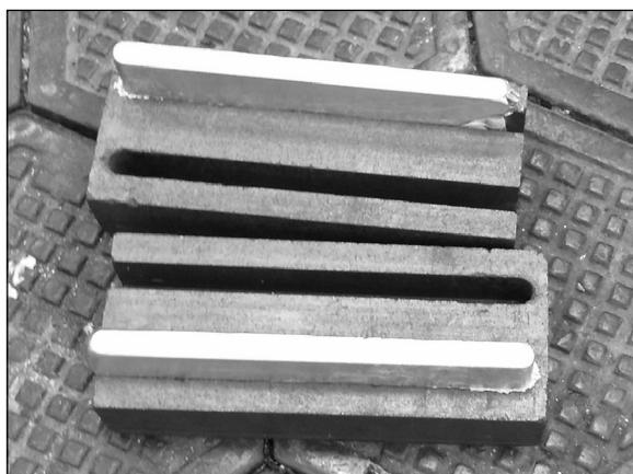
Рис. 1. Экспериментальные образцы (10×40×200 мм) в графитовой изложнице
