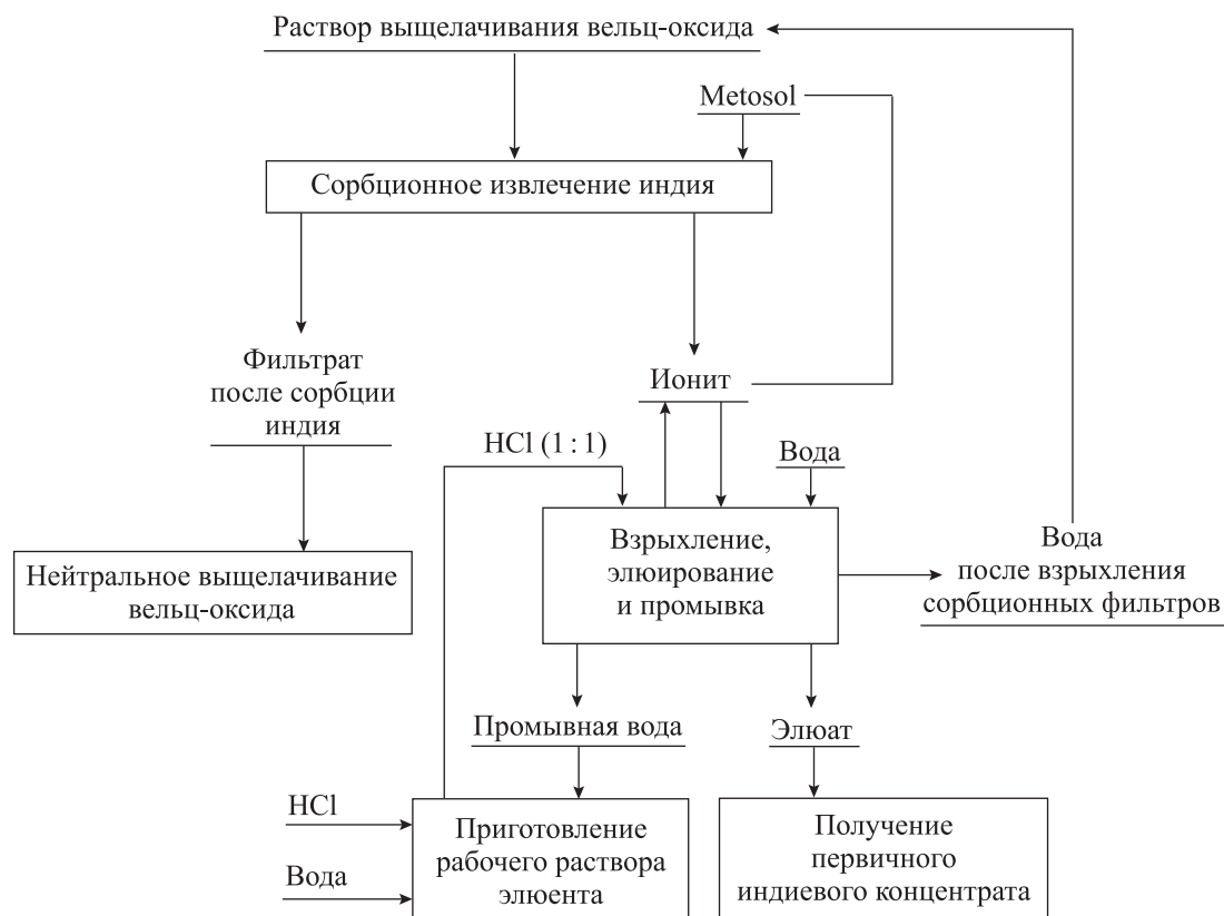
Рис. 2. Принципиальная технологическая схема извлечения индия из растворов цинкового производства
