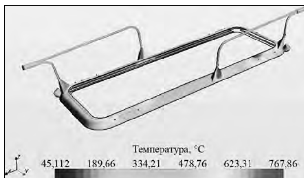
Рис. 5. Температурное поле в системе удаления газов
