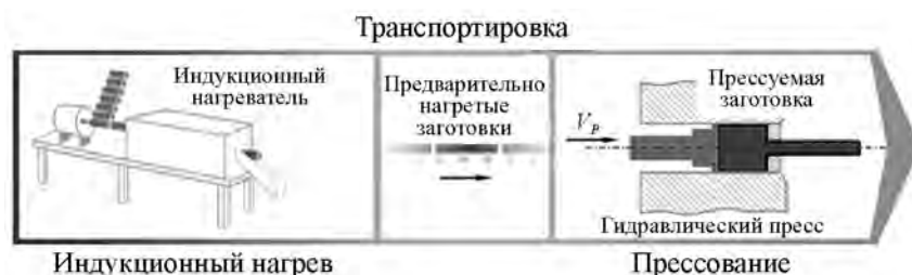
Рис. 1. Стадии обработки заготовки в производственном комплексе «индукционный нагрев – прессование»
