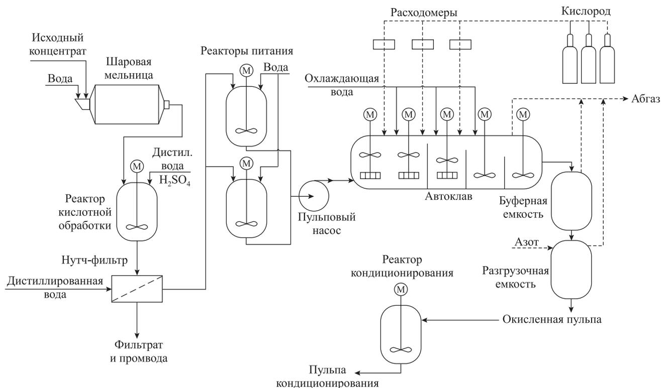
Рис. 1. Схема пилотной автоклавной установки
