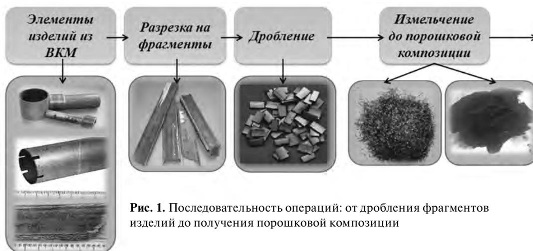
**Рис. 1.** Последовательность операций: от дробления фрагментов изделий до получения порошковой композиции
