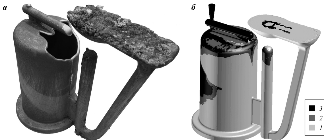
Рис. 5. Сравнение недоливов в реальной отливке из сплава МЛ5 (а) и при моделировании (б) при критической доле твердой фазы 0,1 для температуры заливки 670 °С
