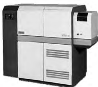
Масс-спектрометр с тлеющим разрядом «Finnigan ELEMENT GD» (Thermo Fisher Scientific, Германия)
