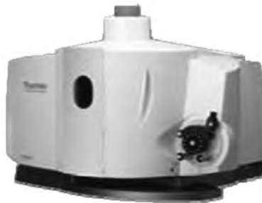
Атомно-эмиссионный спектрометр с индуктивно связанной плазмой iCAP 6300 (Thermo Electron Corp., США)
