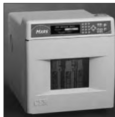
Микроволновая система MARS-5 (CEM, США)
