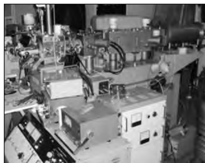
Искровой масс-спектрометр с двойной фокусировкой (JEOL, Япония)
