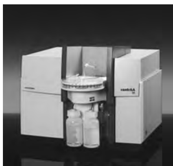
Атомно-абсорбционный спектрофотометр со сплошным спектром «Contr AA 600» (Analytik Jena, Германия)
