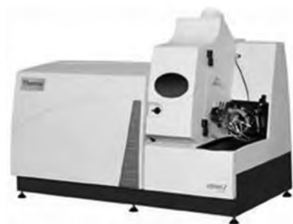
Масс-спектрометр с индуктивно связанной плазмой X-7 (Thermo Scientific, США)
