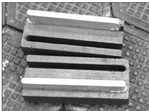
Рис. 1. Экспериментальные образцы (10×40×200 мм) в графитовой изложнице
