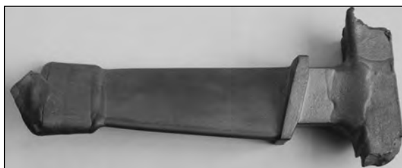
Рис. 2. Литая лопатка компрессора высокого давления
