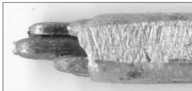
Рис. 6. Обрыв композитной проволоки Cu–Ti Сердечник – 7 волокон начальным диаметром 1,9 мм
