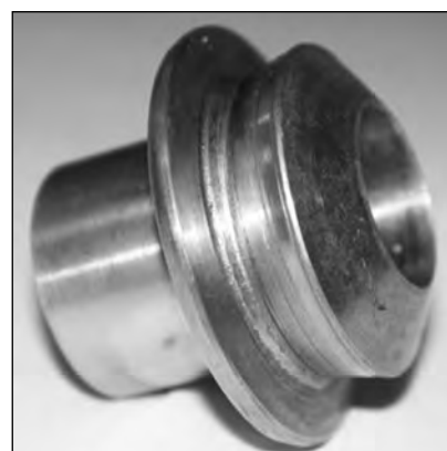
Рис. 6. Заготовка после второго этапа формирования фланца
