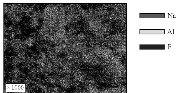
Рис. 5. Распределение основных элементов Na, Al и F в \text{NaAlF}_4 по зерну
