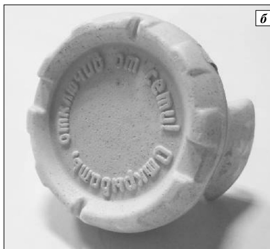
Пенополистироловая модель для отливки крышки корпуса газоанализатора с разной плотностью а – \rho = 0,017 г/см 3 ; б – 0,024 г/см 3
