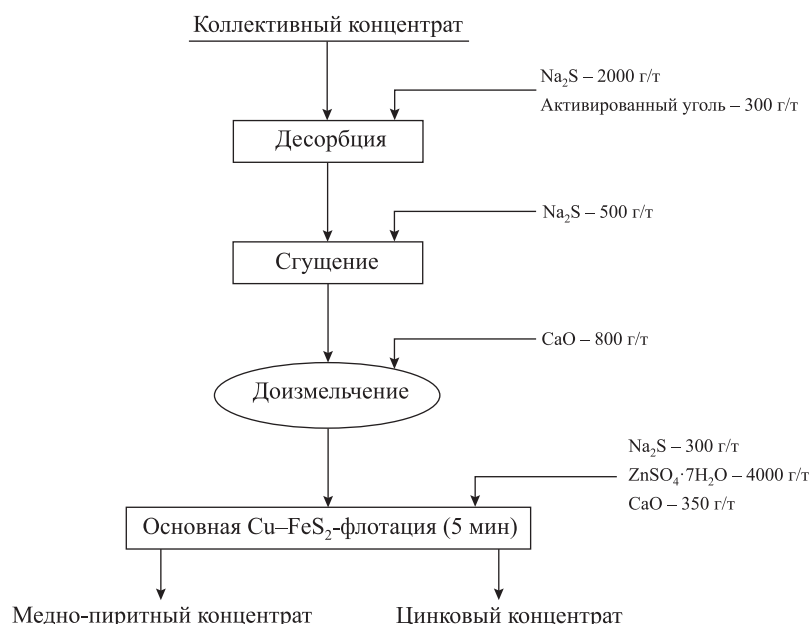
Рис. 2. Схема селекции коллективного медно-цинкового концентрата
