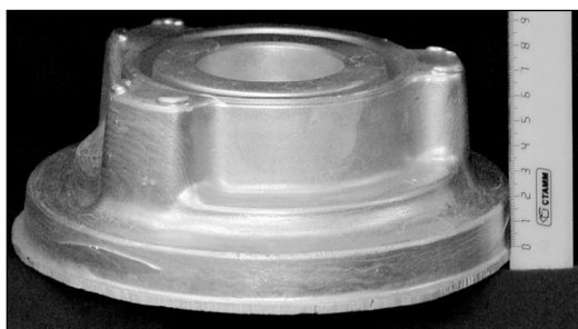
Рис. 1. Штампованная поковка «Крышка» из сплава АК6
