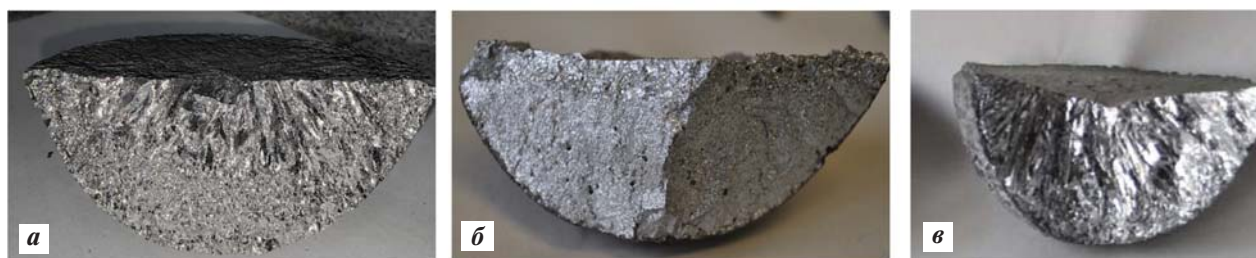
Рис. 6. Внешний вид макроструктуры слитков (массой 1–1,45 кг) синтезированных сплавов Cr–Mo (Al) ( а ), Cr–W (Al) ( б ) и Cr–Al ( в )
