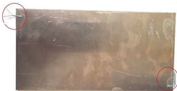
Рис. 2. Образцы, подготовленные для асимметричной аккумуляторной прокатки с предварительным соединением их тонкой проволокой
