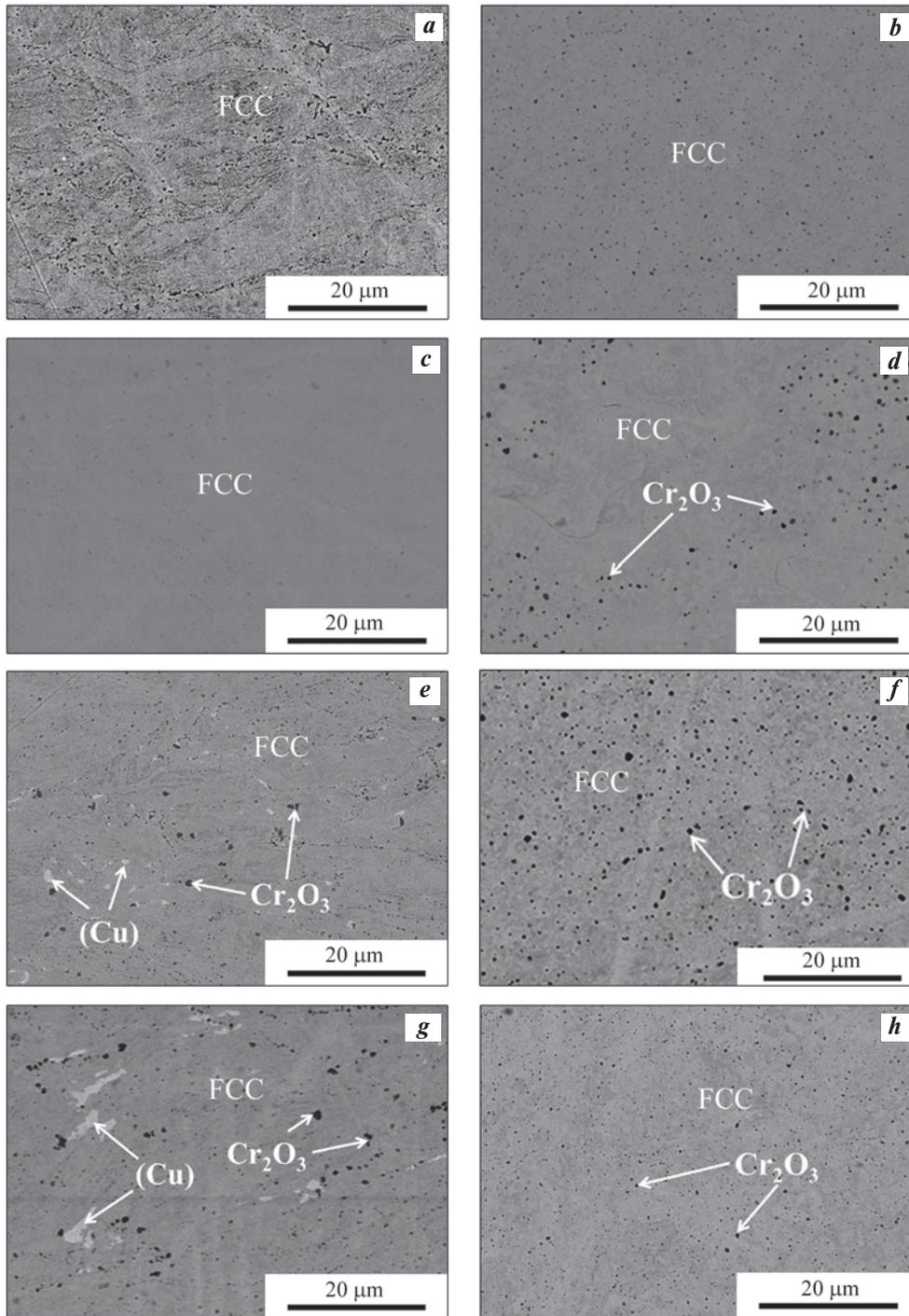
**Рис. 5.** Микроструктура ВЭС CoCrCu<sub>x</sub>FeNi<sub>2</sub> после ГП (a, c, e, g) и ГП + ТО (b, d, f, h)
