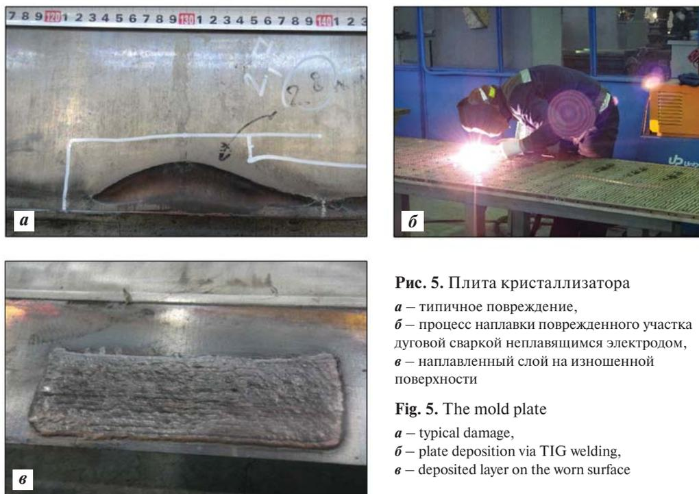
**Рис. 5.** Плита кристаллизатора
