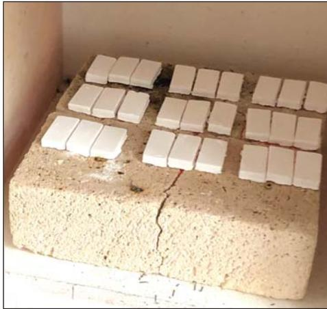
Рис. 2. Керамические образцы после прокалики для механических испытаний
