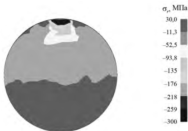
Рис. 8. Глубина залегания и распределение радиальных остаточных напряжений ( \sigma_r ) в поперечном сечении заготовки для R3 и A = 50 мкм
