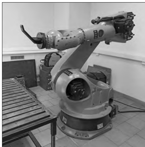
Рис. 1. Промышленный робот манипулятор KUKA KR-210-2 2000 со специализированной оснасткой для крепления сварочной горелки
