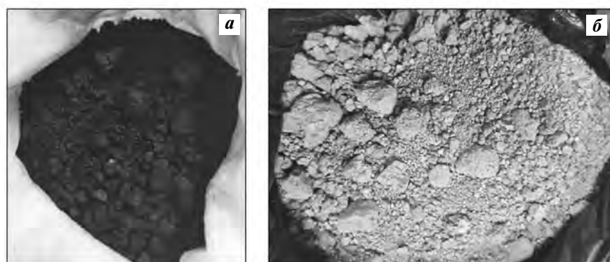
Рис. 1. Промышленный Те-содержащий промпродукт ТОО «Корпорация Казахмыс» (Казахстан) в состоянии поставки (а) и после хранения в течение 2 лет (б)
