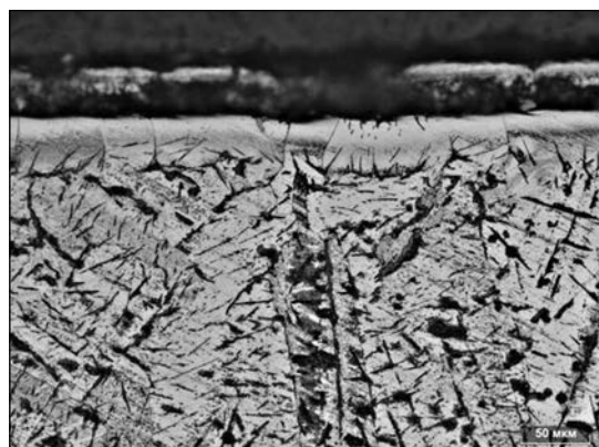
Рис. 2. Карбоборидный слой на титане VT1-0 (смесь 2) Fig. 2. Carboboride layer on VT-1.0 titanium (Mixture 2)
