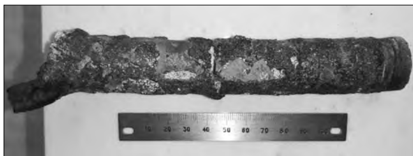
Рис. 7. Образец композита TiC-Al после горизонтальной спутной пропитки расплавом с t = 900^\circ C [87]
