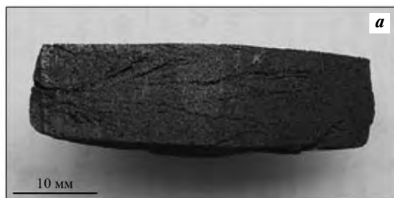
Рис. 2. Макроструктура каркаса \text{Ti}_2\text{AlC} до пропитки (а) и кермета \text{Ti}_2\text{AlC}-\text{Al} после нее (б) [81]
