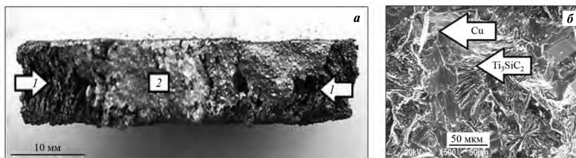
Рис. 3. Макрофотография скола нижнего образца \text{Ti}_3\text{SiC}_2 после пропитки расплавом \text{Cu-10\%Si} с задержкой зажигания верхнего шихтового брикета в течение 10 с (а) и микроструктура участка пропитки (б) [83]
