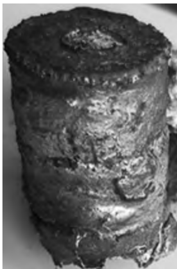
Рис. 9. Композит TiC—Al после вертикальной спутной пропитки расплавом с t = 900\text{ °C} [87]
