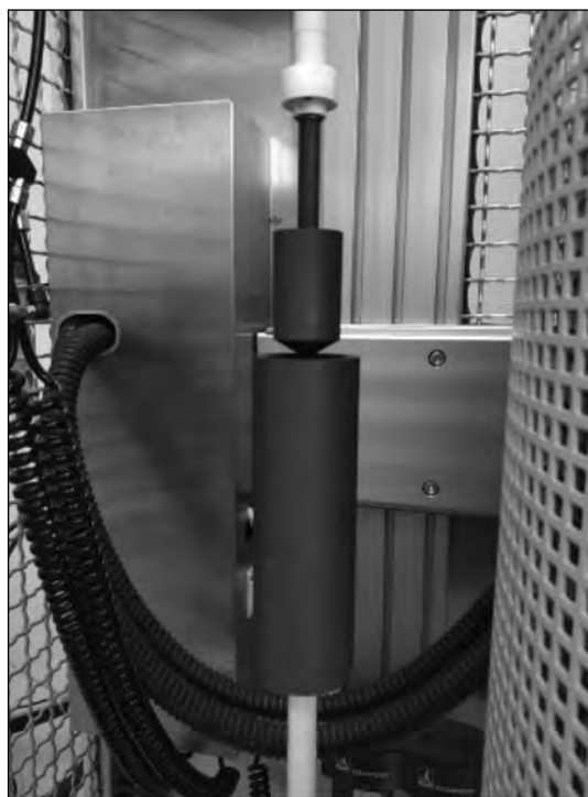
Рис. 2. Фотография внутреннего и внешнего цилиндров перед началом измерений
