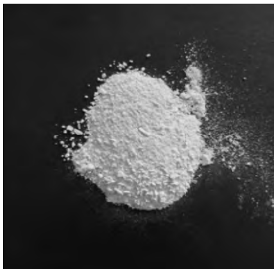
Рис. 4. Фотография образца криолита, полученного из фторсодержащего раствора гидрометаллургической обработки пробы лежалого шлама
