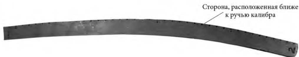
Рис. 3. Латунная планка после замера зазора между валками на стане ХПТ-55 при прокатке трубы из стали 20 по маршруту 57×4,0–30×2,0 [22]
