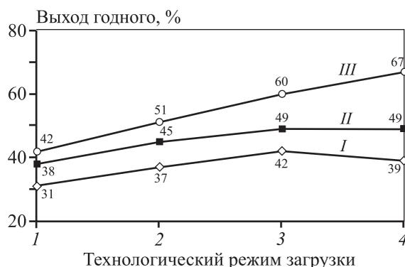
**Рис. 1.** Влияние температуры отжига и технологии загрузки стружки на выход годного металла
