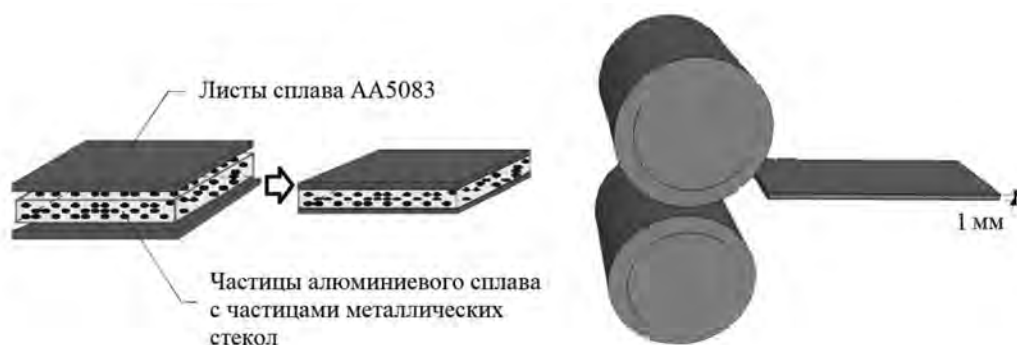
Рис. 1. Схема получения листов методом прокатки
