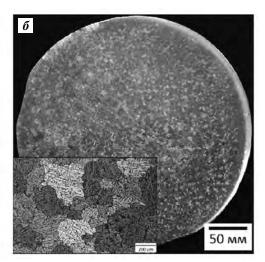
**Рис. 3.** Зеренная структура экспериментальных сплавов Al-5,5Zn-1,5Mg (a) и Al-5,5Zn-1,5Mg-1Ca-0,5Fe (б)
