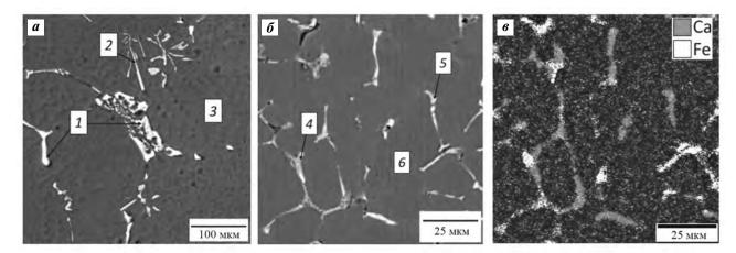
Рис. 5. Морфология интерметаллидных фаз в сплаве Al-5,5Zn-1,5Mg-1Ca-0,5Fe (СЭМ)
