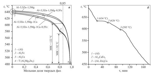
Рис. 2. Неравновесная кристаллизация экспериментальных сплавов
