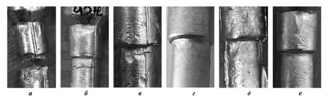
Рис. 1. Горячеломкость экспериментальных сплавов
