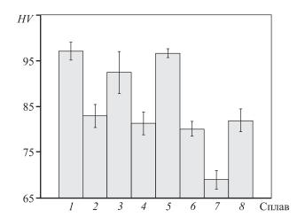
**Рис. 6.** Твердость экспериментальных сплавов в литом состоянии
