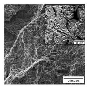
**Рис. 7.** Фрактограмма разрывного образца из экспериментального сплава Al-5,5Zn-1,5Mg-1Ca-0,5Fe в литом состоянии
