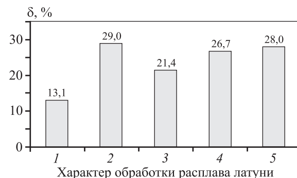
Рис. 2. Влияние обработки тройными карбонатами на пластичность латуни (средние значения)
