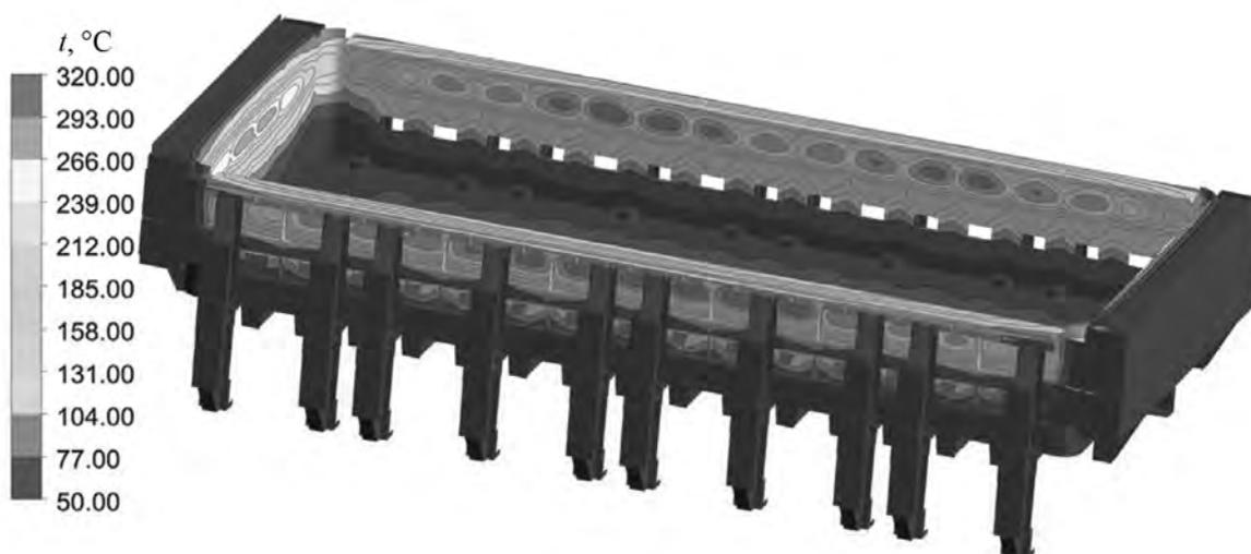
Рис. 7. Распределение температуры в кожухе (входной торец справа)
